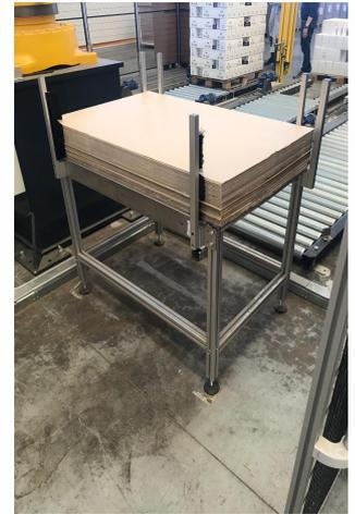
Ad ogni strato completato il robot preleva l'interfaldia dal magazzino (se previsto dal formato)
