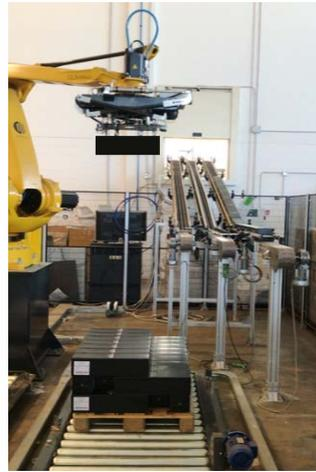
Dopo avere prelevato il robot deposita il prodotto nel relativo pallet
