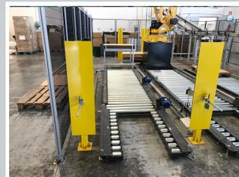
L'isola di pallettizzazione E-PAL 3 è un sistema composto da un Robot Antropomorfo in grado di gestire fino a 3 linee di prodotto in ingresso ed altrettante rulliere di uscita per scarico pallet pieni.
